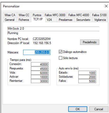
Los controles de soldadura se pueden conectar simultáneamente al CPC-Connect y al SGateway. La única precaución a tener en cuenta es que el modo **Diálogo automático** esté activado en la pestaña **TCP/IP** del diálogo **Opciones – Personalizar** del CPC-Connect (opción por defecto).
