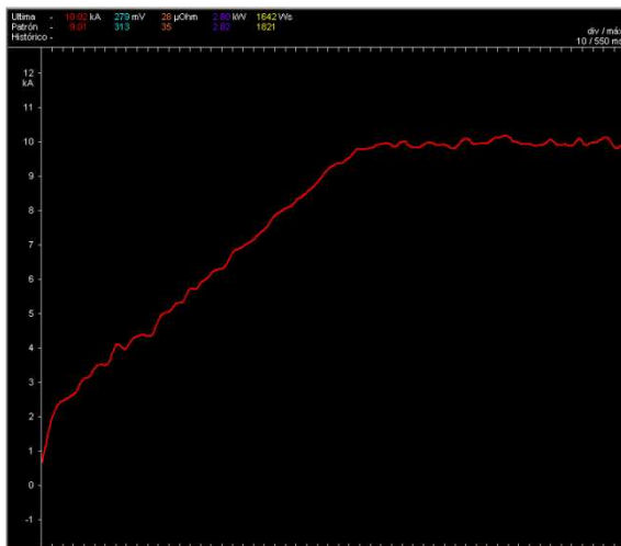
Pendiente de subida corriente soldadura
